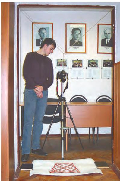
Рис. 4. Двухчастотный маятник, снабженный лазерной указкой
